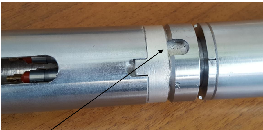
Места для фиксации стопорных колец деформированием
